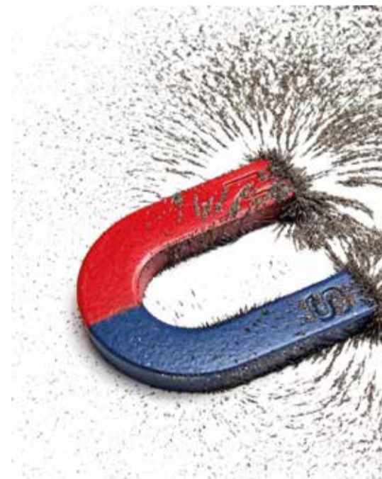
FIGURA 3. EL campo magnético de un imán en forma de herradura. Tomada de https://www.tiempo.com/noticias/ciencia/sabes-como-funcionan-los-iman-es-el-magnetismo-es-la-clave.html
