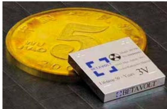
Las baterías nucleares generan energía aprovechando partículas de alta energía emitidas por materiales radiactivos. No todos los elementos radiactivos emiten radiación dañina para los organismos vivos, y ciertos materiales pueden bloquear cierta radiación. Por ejemplo, las partículas beta (también conocidas como rayos beta) pueden protegerse con una fina lámina de aluminio, lo que convierte a la energía betavoltaica en una opción potencialmente segura para las baterías nucleares.
